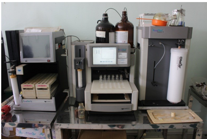
Hình: Sinh viên tìm hiểu về các máy sắc ký trung áp có khả năng tách và tinh chế các hợp chất. Phương pháp sắc ký cột thông thường.
