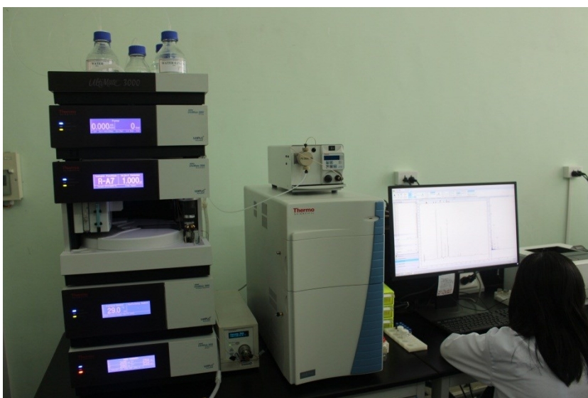
Máy sắc ký lỏng cao áp (HPLC) ghép đầu dò MS (Mass spectrum) là 1 trong các máy phân tích các chất đắt tiền nhất (khoảng 5 tỷ đồng).
