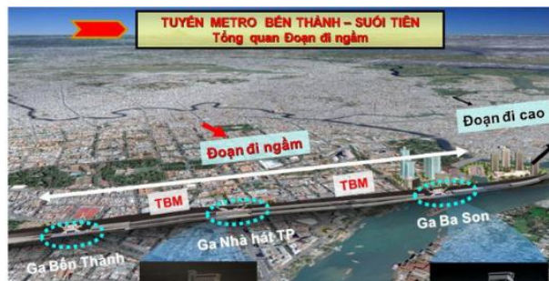
Hình 3: Tuyến có một phần đi ngầm (đào bằng TBM) được nghiên cứu
