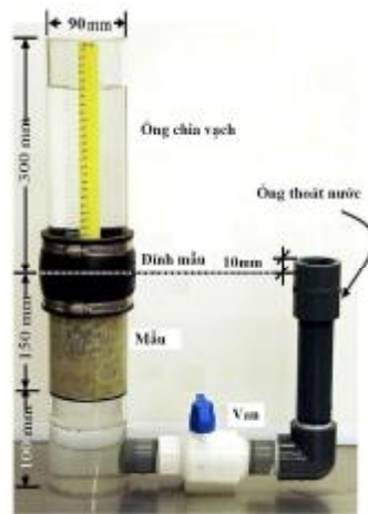
Hình 3 : Dụng cụ thí nghiệm hệ số thấm
